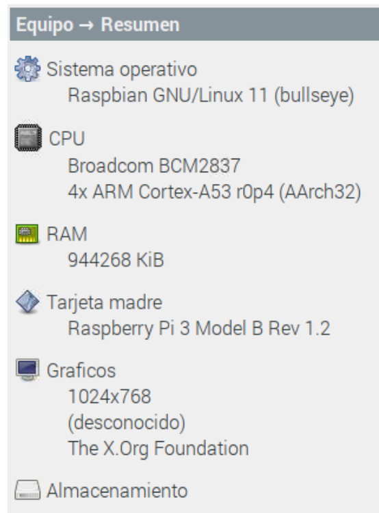
Figura 16: Hardware del Servidor Raspberry Pi del Datacenter
