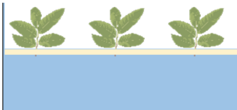
Figura 7 - Sistema de raíz flotante [17].
