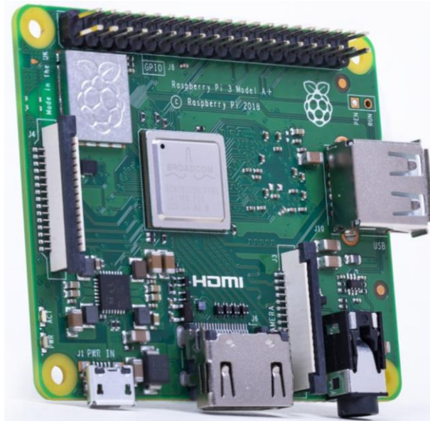
Figura 28 - Placa Raspberry Pi 3 Modelo A+ [61].
