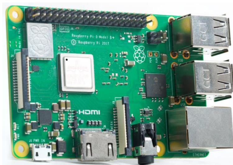
Figura 27 - Placa Raspberry Pi 3 Modelo B+ [59].
