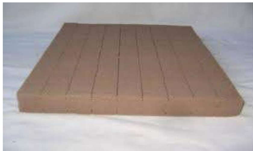
Figura 16 - Espuma fenólica pre moldeada [17].
