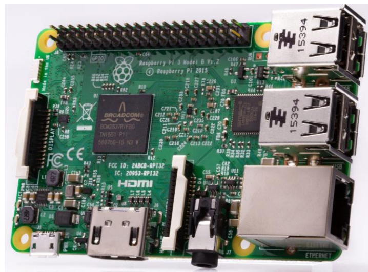
Figura 25 - Placa Raspberry Pi 3 Modelo B [56].
