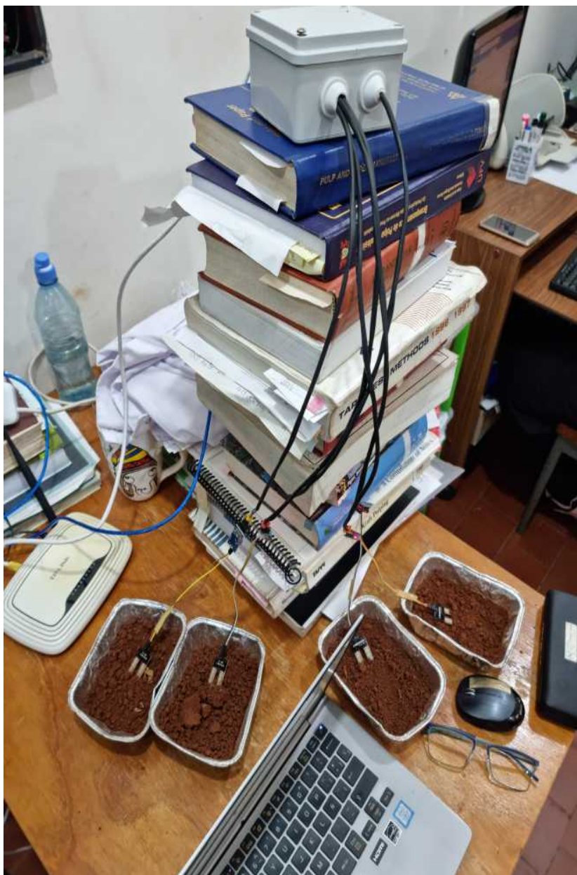
Figura 53: Caja estanco y recipientes con sus respectivos sensores
