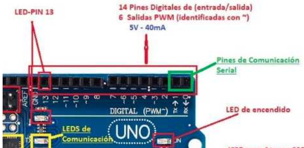
Figura 3: Pines digitales de Entrada Salida
