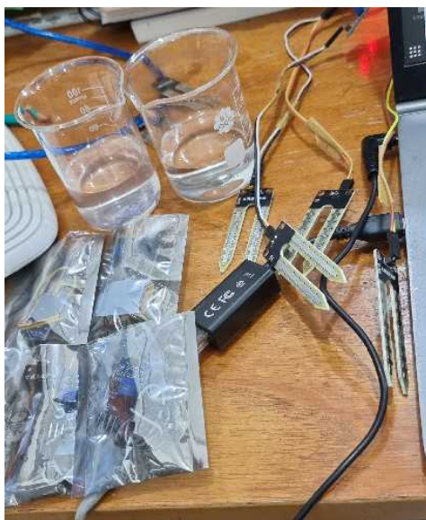
Figura 57: Cambio de sensores YL69
